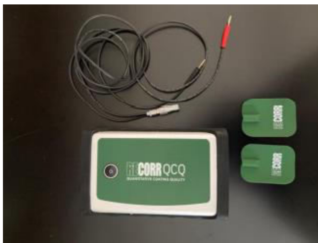
Slika 12 ReCorr® QCQ uređaj za mjerenje impedancije
