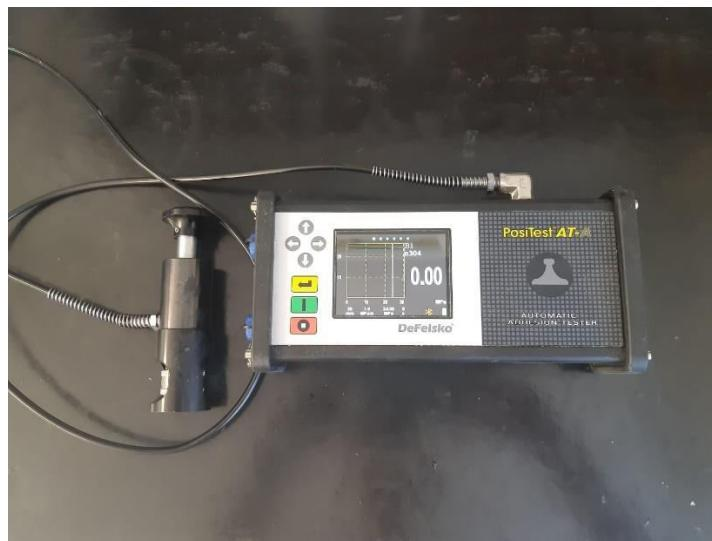
Slika 18 Ispitivač vlačne sile
