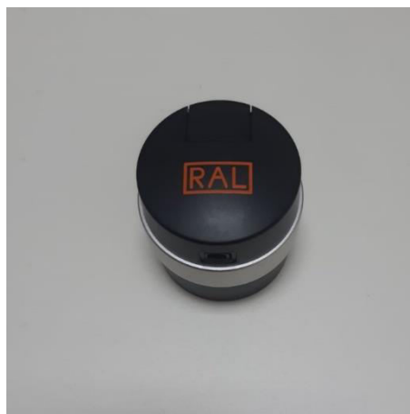
Slika 17 Uređaj za mjerenje boje
