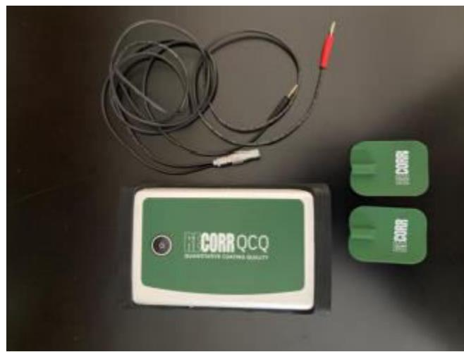
Slika 12 ReCorr® QCQ uređaj za mjerenje impedancije
