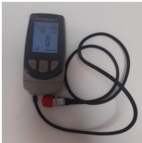
Slika 15 Uređaj za mjerenje debljine premaza
