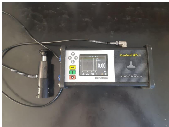
Slika 18 Ispitivač vlačne sile
