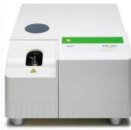
Slika 8. Fotografija diferencijalnog pretraženog kalorimetra Mettler Toledo 822e (Mettler Toledo GmbH, Greifensee, Švicarska)
