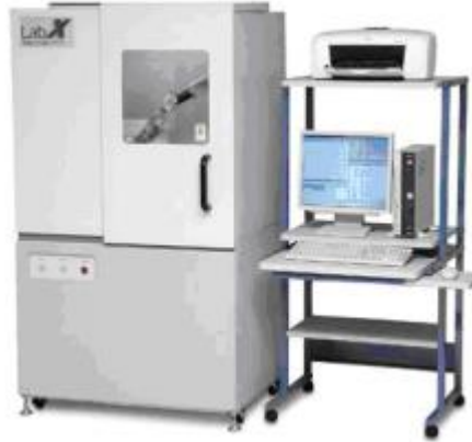
Slika 13. Fotografija uređaja za rendgensku difrakcijsku analizu praha XRD-6300 (Shimadzu, Kyoto, Japan)
