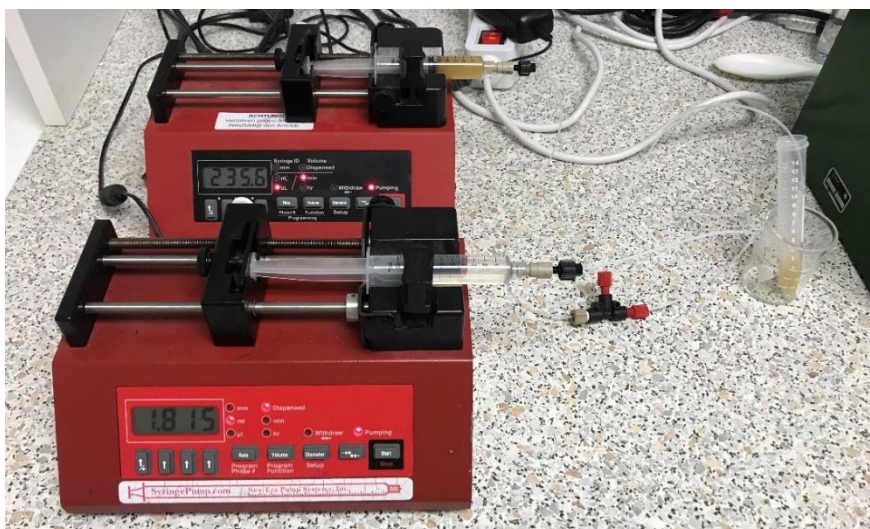
Slika 2. Aparatura za provedbu pročišćavanja enzima endo -1,4-ksilanaze u mikroekstraktoru
