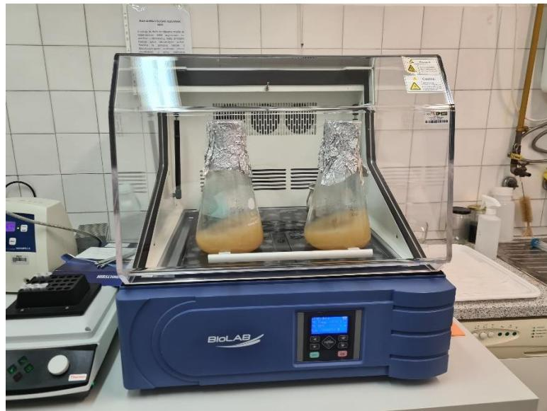
**Slika 3.1.** Tresilica inkubator
