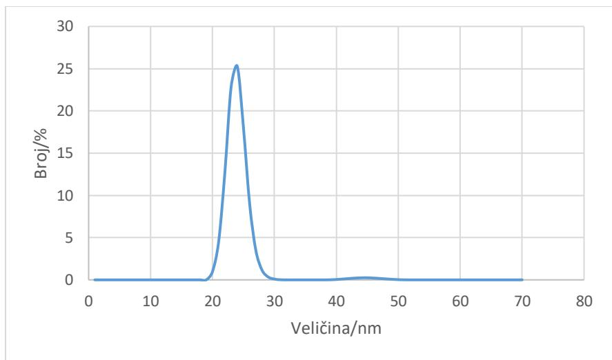
**Slika 4.4.** Volumna raspodjela enzima N-acetylneuraminat sintaze dobivena na Zetasizeru (09. 06. 2022.)
