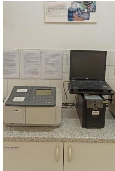
**Slika 3.5.** Spektrofotometar
