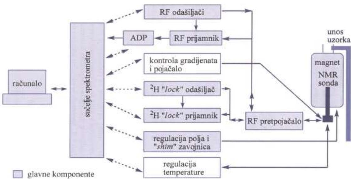
**Slika 4.** Shematski prikaz modernog NMR spektrometra [5].
