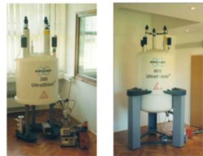
Slika 5. Bruker 300 i 600 MHz spektrometri na Institutu Ruđer Bošković u Zagrebu
