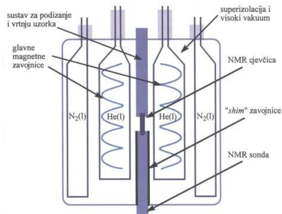
**Slika 3.** Prikaz unutrašnjosti magneta NMR spektrometra [5].
