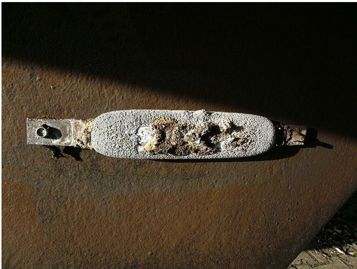
Slika 16. Primjer trošenja žrtvovane anode na trupu broda 28
