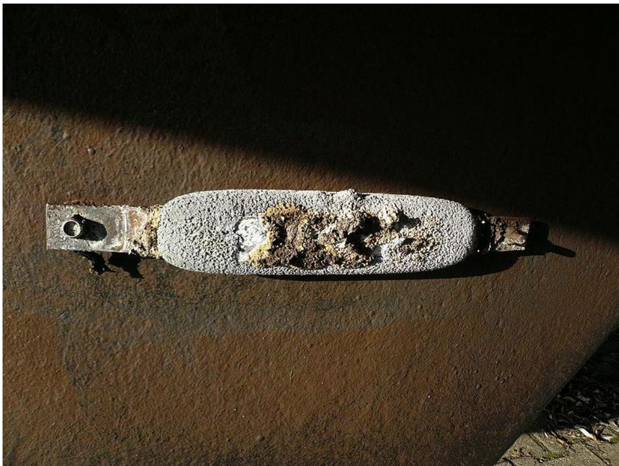
Slika 16. Primjer trošenja žrtvovane anode na trupu broda<sup>28</sup>
