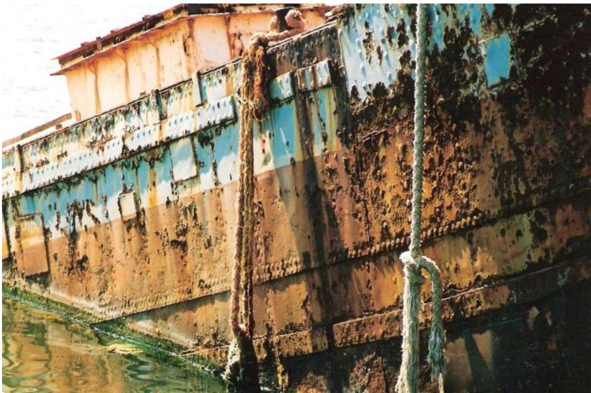
*Slika 5. Opća korozija<sup>33</sup>*
