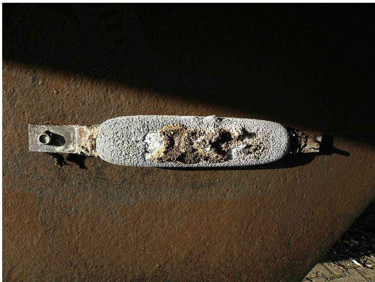
Slika 16. Primjer trošenja žrtvovane anode na trupu broda 28
