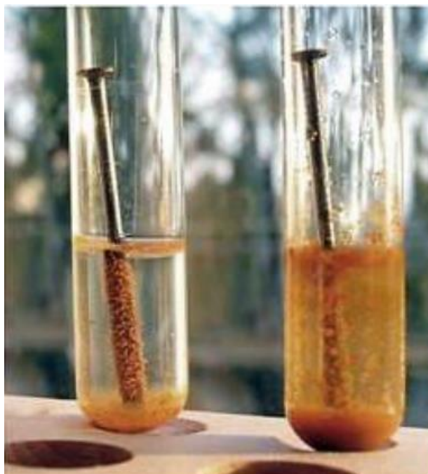
Slika 4. Prikaz željeznih čavala nakon 7 dana stajanja u a) običnoj vodi (lijevo) i u b) morskoj vodi (desno) 5
