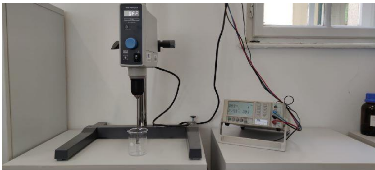
Slika 11. Miješalica (VELP Scientifica, Italija) i analizator snage (PCE Group, Engleska)
