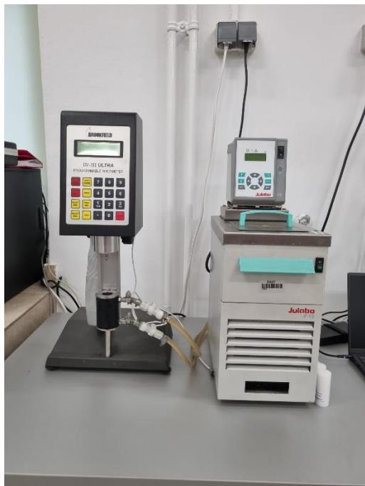
**Slika 7.** Reometar (Brookfield, Kanada) i termostat (Julabo, Njemačka)
