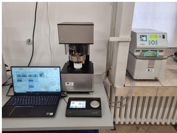
**Slika 8.** Tenziometar (Dataphysics, Njemačka) i termostat (Julabo, Njemačka)
