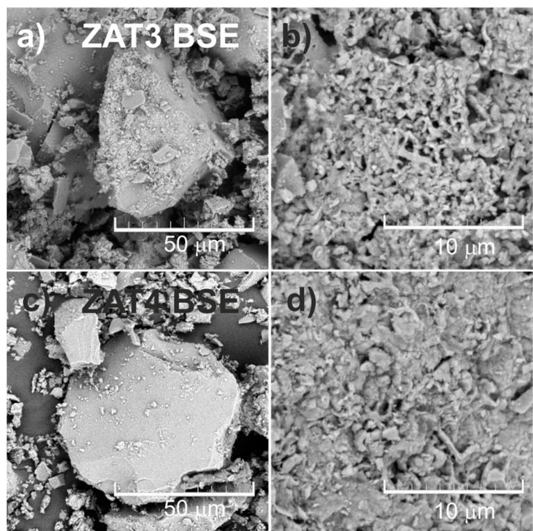
Slika 26 SEM BSE eletronima uzorka ZAT 4 pri dva povečanja
