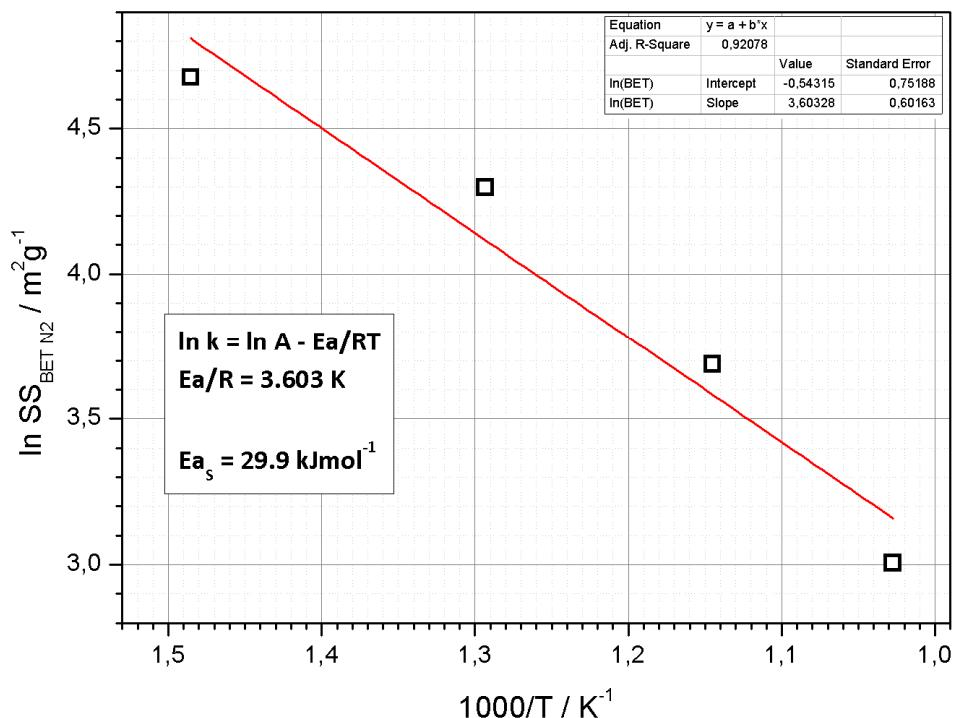
Slika 23 Kinetika sinteriranja uzorka ZAT3
