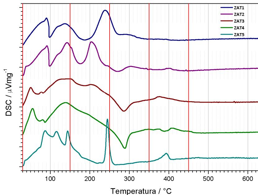
Slika 12 Diferencijalna pretražna kalorimetrijska analiza svih ZAT uzoraka gelova, izbor temperatura termičke analize.
