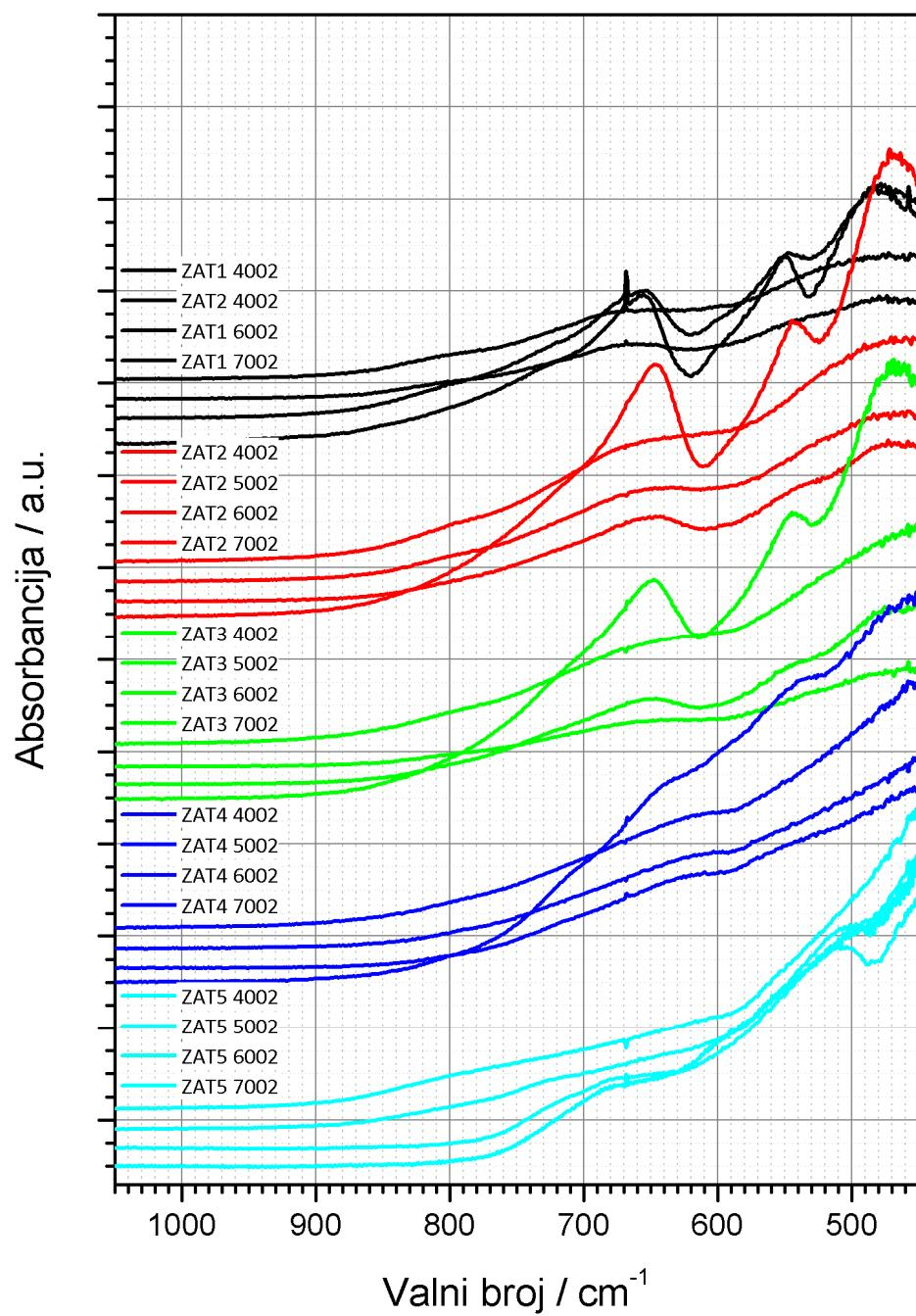
**Slika 15 Infracrveni spektri uzoraka ZAT 1- ZAT 5 termički obradenih pri temperaturi od 400, 500, 600 i 700 °C u trajanju od 2h**
