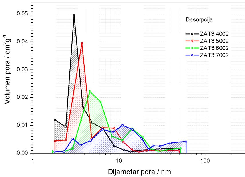
**Slika 20 Raspodjela veličine pora tijekom desorpcije uzorka ZAT 3 termički obradenih pri temperaturi od 400, 500, 600 i 700 °C u trajanju od 2h**
