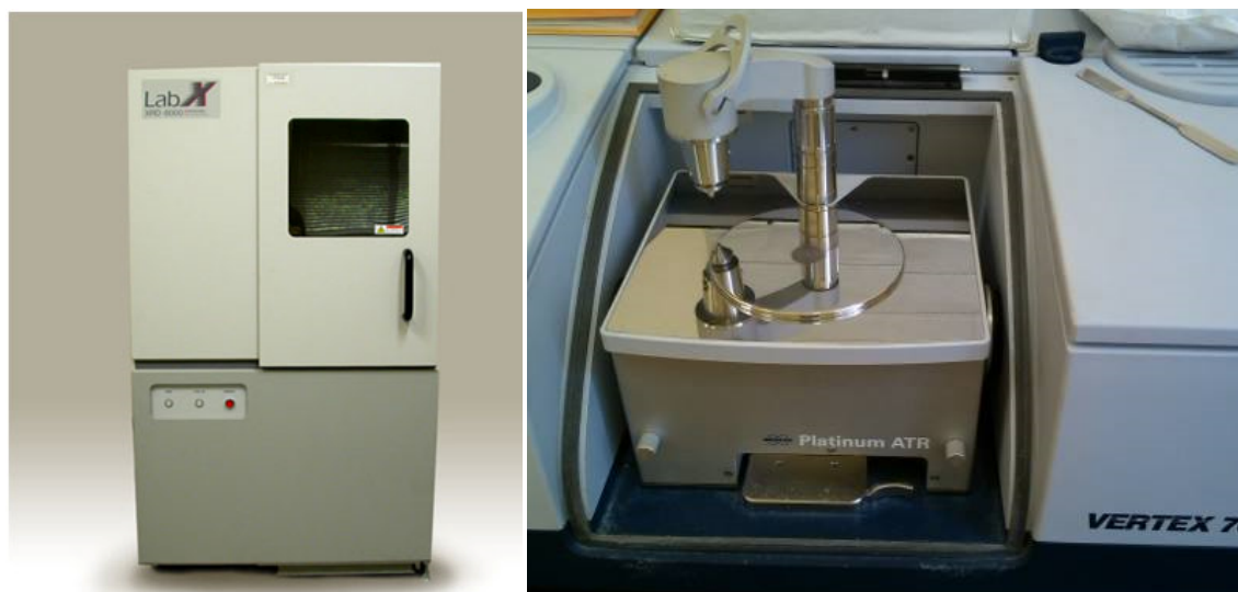
Slika 10 Uređaji LabX XRD - 6000 (lijevo) i Bruker Vertex 70 FT-IR (desno)
