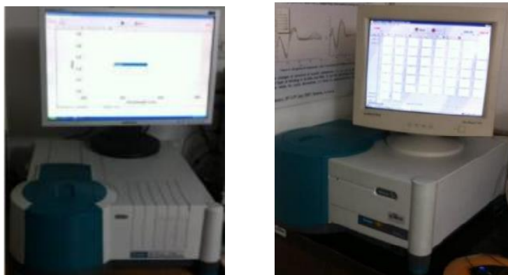
Slika 20. UV-vidljivi apsorpcijski spektrofotometar Cary 100 Scan (lijevo), i fluorescencijski spektrofotometar Cary Eclipse (desno)
