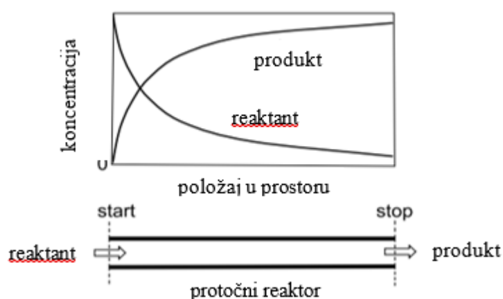
Slika 1. Profil reakcije u protočnom reaktoru 12 .
