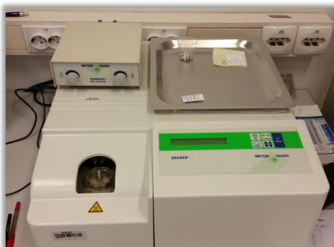
Slika 19. Fotografija diferencijalnog pretražnog kalorimetra Mettler Toledo 822 e (Mettler Toledo GmbH, Griefensee, Švicarska)
