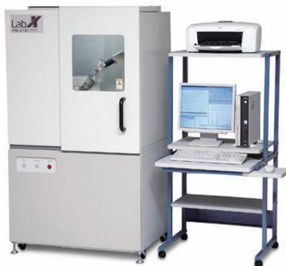
Slika 24. Difraktometar Shimadzu XRD 6000 (Shimadzu, Kyoto, Japan)
