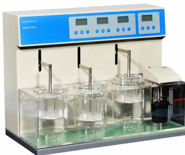
Slika 26. Fotografija uređaja za ispitivanje raspadljivosti tableta BJ 2 (Zhengzhou Nanbei Instrument, Henan, NR Kina)
