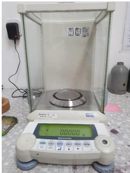
Slika 12. Analitička vaga Shimadzu.
