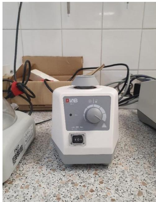
**Slika 16.** Homogenizator *DLAB MX-S*.
