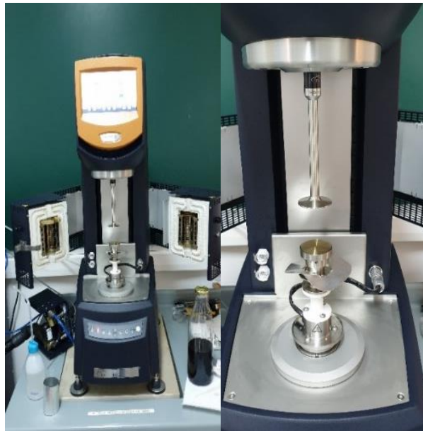
Slika 3.15. Prikaz aparature za ispitivanje reoloških svojstva
