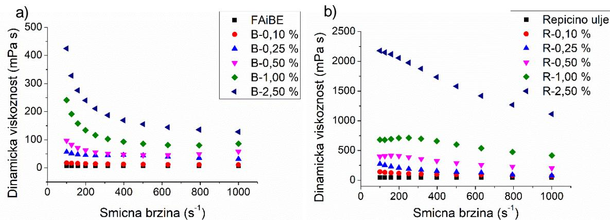
**Slika 4.11.** Ovisnost dinamičke viskoznosti nanofluida o smičnoj brzini za
