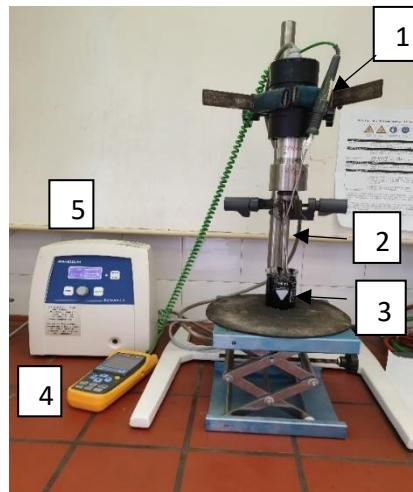
**Slika 3.10.** Prikaz aparature za homogenzaciju nanofluida:
