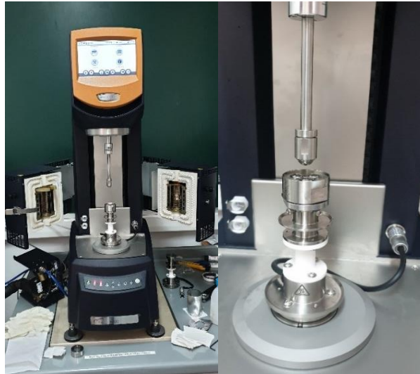
Slika 3.19. Prikaz aparature za ispitivanje mazivosti
