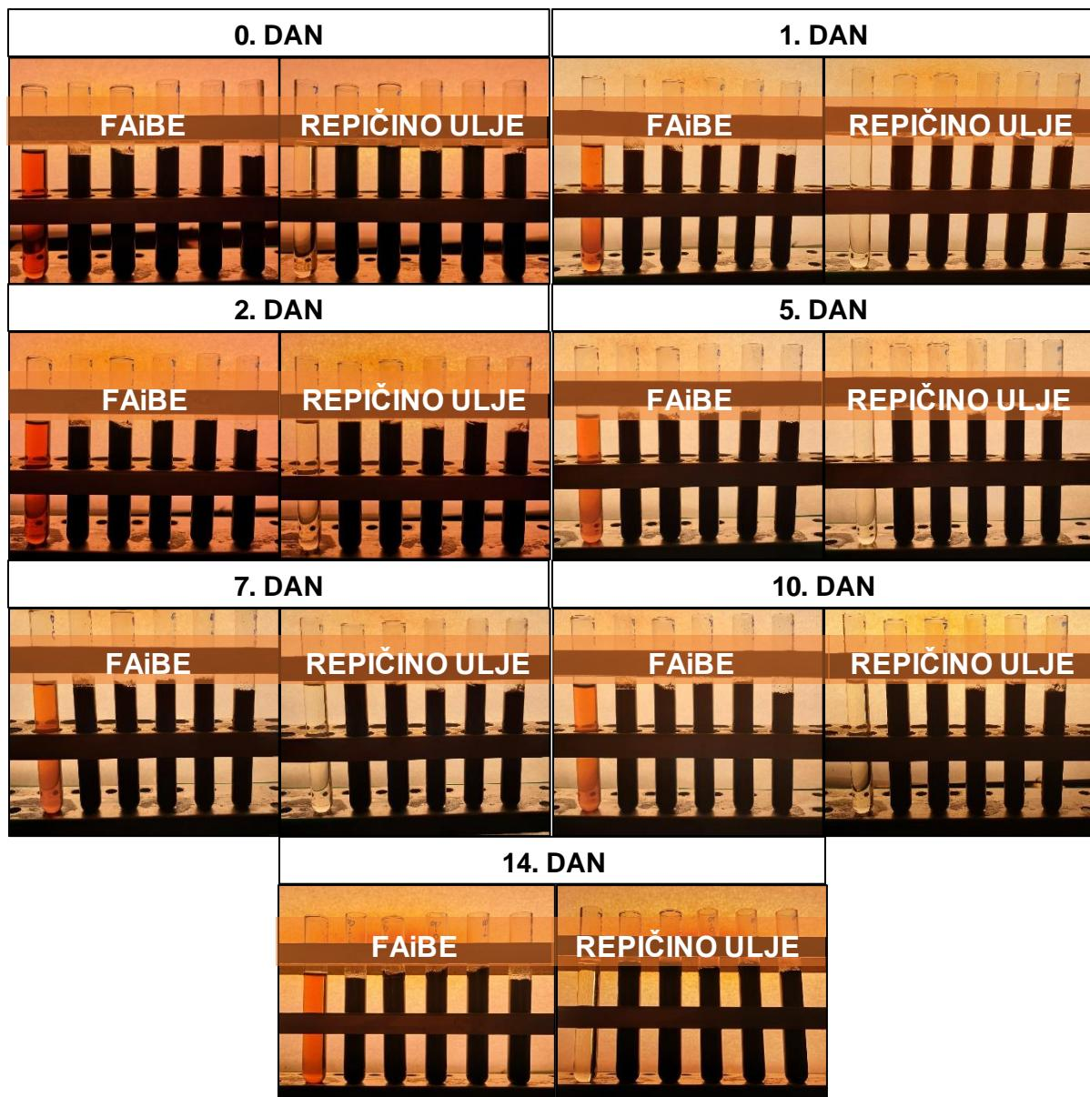
**Slika 4.7.** Gravitacijska stabilnost uzorka za 0. dan, 1. dan, 2. dan, 5. dan, 7. dan, 10. dan i 14. dan za obje vrste nanofluida (koncentracija se povećava s lijeva na desno)
