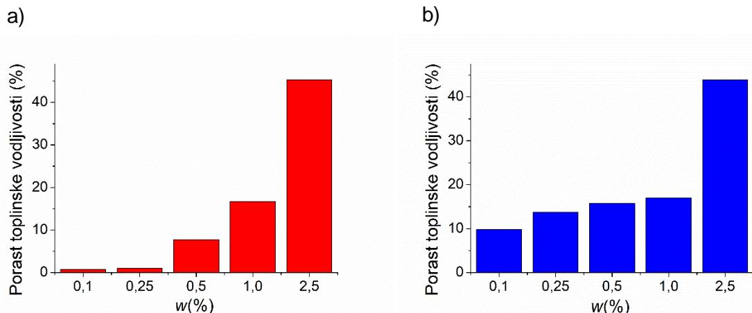
**Slika 4.10.** Porast toplinske vodljivosti u odnosu na bazni fluid za nanofluide na osnovi
