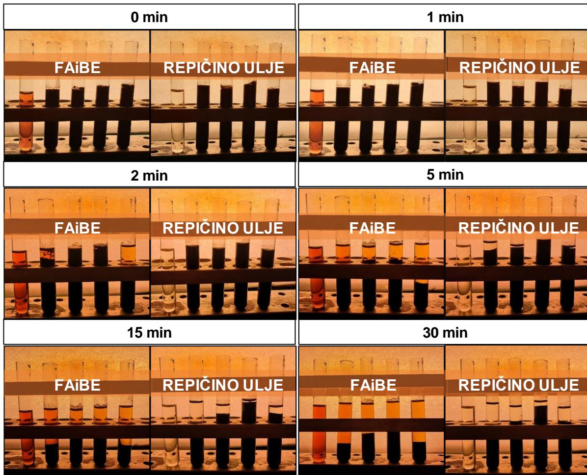
**Slika 4.8.** Prisilna stabilnost uzorka prije početka mjerena i nakon centrifugiranja za obje vrste nanofluida (koncentracija se povećava s lijeva na desno)
