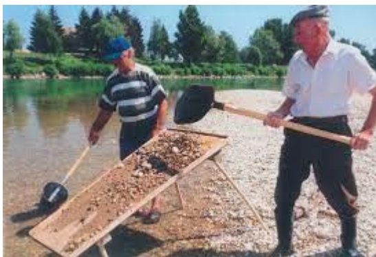
Slika 3. Alat za ispiranje zlata (preuzeto iz literaturnog izvora [5])
