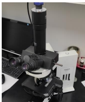
Slika 3.6. Svjetlosni mikroskop Olympus BX50 opremljen kamerom.
