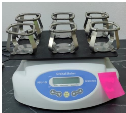
Slika 3.5. Rotacijska tresilica korištena za provedbu pokusa.
