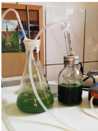
Slika 3.3. Uzgoj mikroalge Chlorella sp. u bazalnom mediju uz aeraciju.
