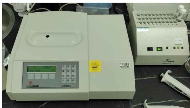
Slika 3.7. Provođenje testa ekotoksičnosti na luminometru primjenom morske bakterije Vibrio fischeri .
