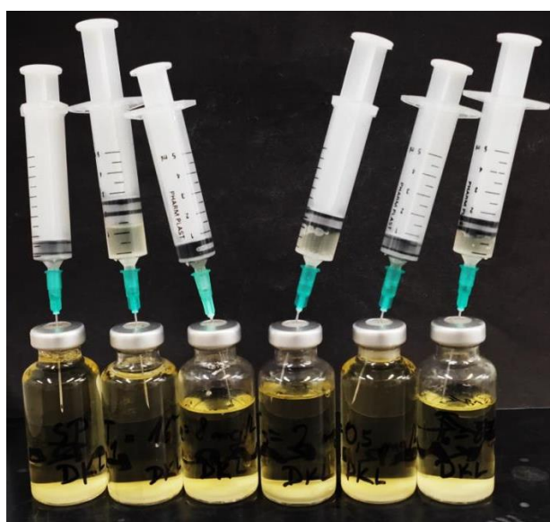
Slika 3.9. Provođenje testa ekotoksičnosti diklofenaka primjenom kvasca Saccharomyces cerevisiae .
