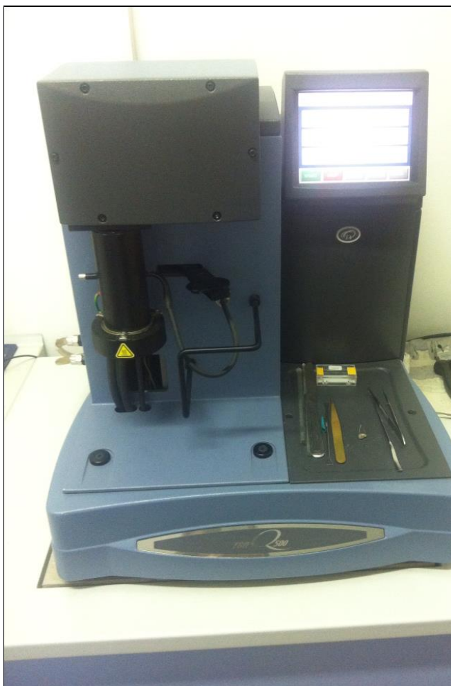
Slika 7. TGA instrument, Fakultet kemijskog inženjerstva i tehnologije.
