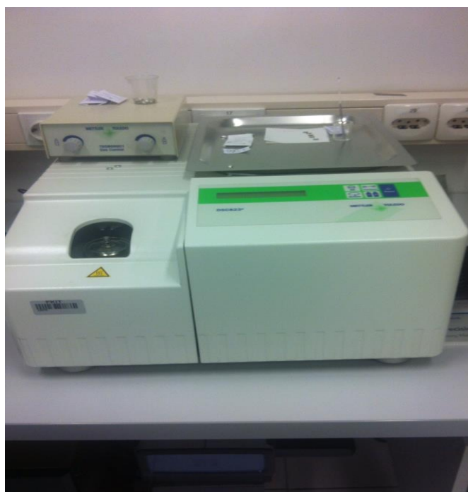
Slika 11. DSC instrument, Fakultet kemijskog inženjerstva i tehnologije.
