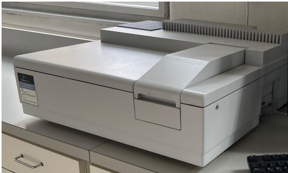
Slika 21. Spektrofotometar Perkin Elmer Lambda 35
