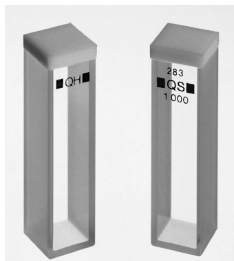
Slika 11. Par kiveta namijenjen za snimanje pri UV/VIS spektrofotometriji [1]
