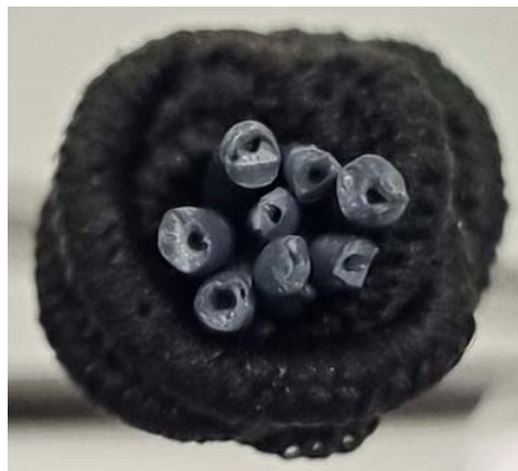
Slika 4.1. Rupe na filamentima nakon ekstrudiranja
