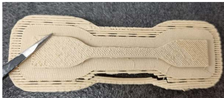
Slika 4.3. Neuspješno 3D-ispisana epruveta
