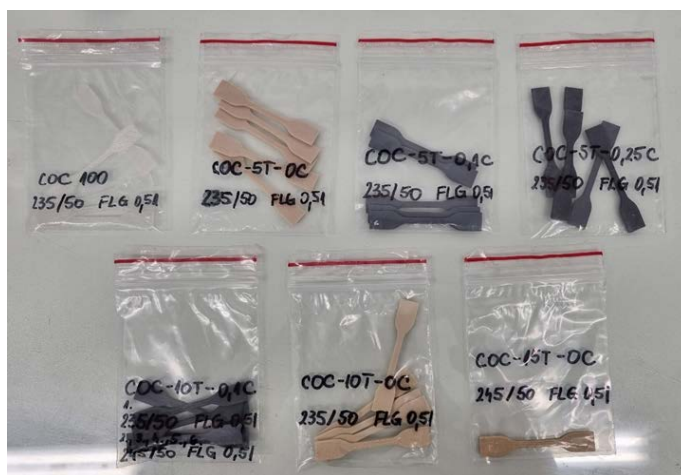
Slika 4.2. Uspješno 3D-ispisane epruvete
