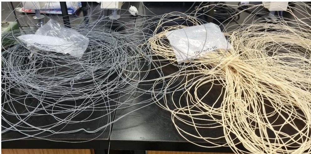
Slika 3.2. Dobiveni ekstrudati sa punilom CNT (sivi) i bez punila CNT (žuti)
