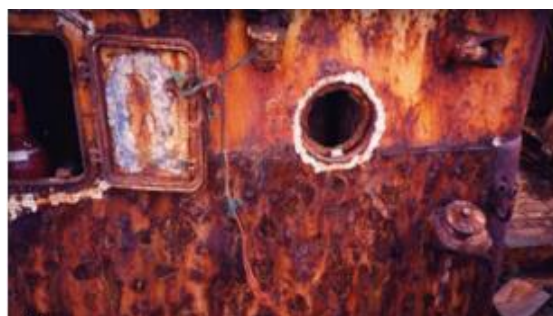
Slika 3. Uvećani prikaz lokalizirane korozije [8]
