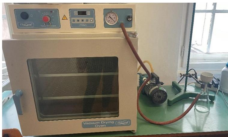
Slika 3.4. Aparatura za vakuum filtraciju
