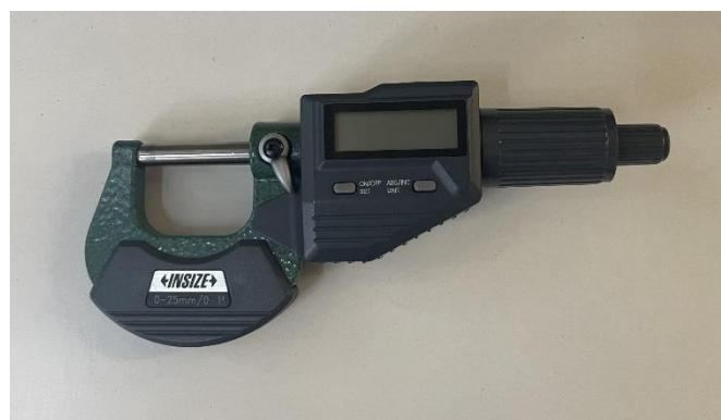
*Slika 3.8. Mikrometar*
