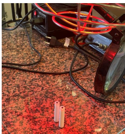
Slika 3.1. Sušenje GC/GO elektroda ispod IR lampe
