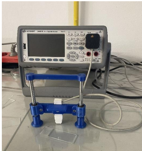
Slika 3.7. Uređaj za mjerenje otpora rGO papira
