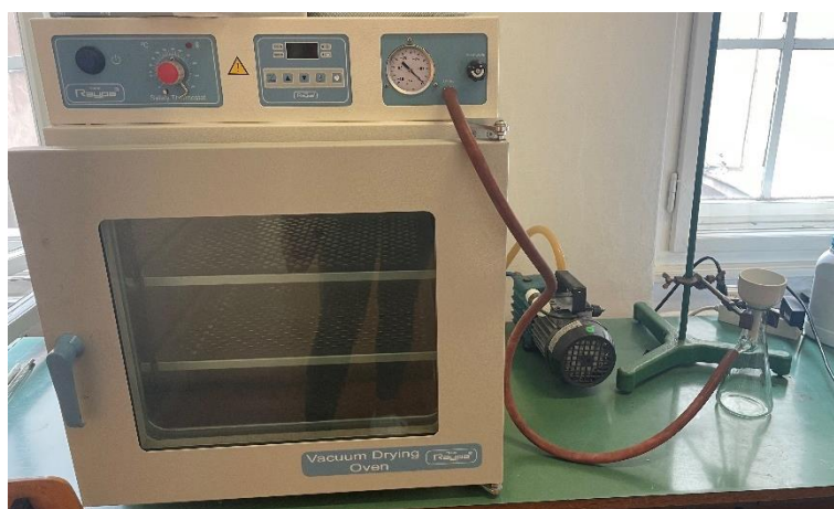
Slika 3.4. Aparatura za vakuum filtraciju
