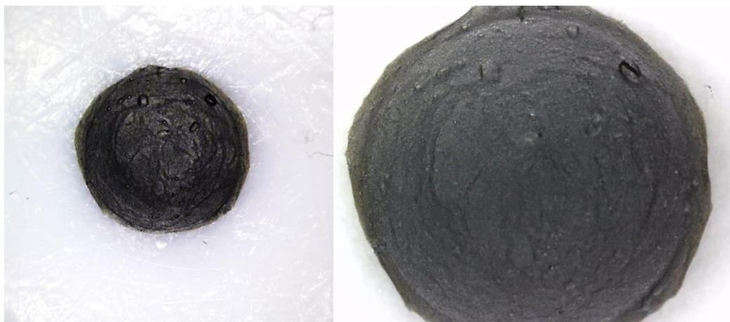
Slika 4.12. Površina GC elektrode sa slojem GO/20 % AC
