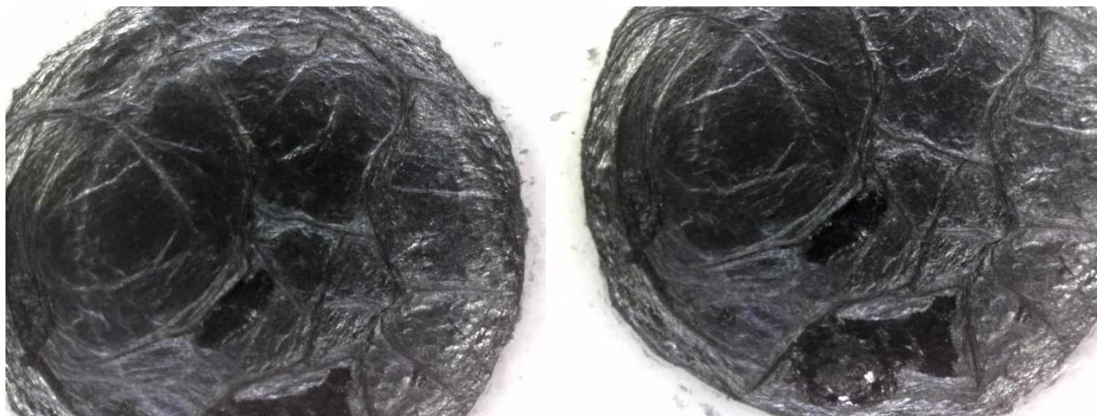
*Slika 4.10.* Površina GC elektrode sa slojem GO
