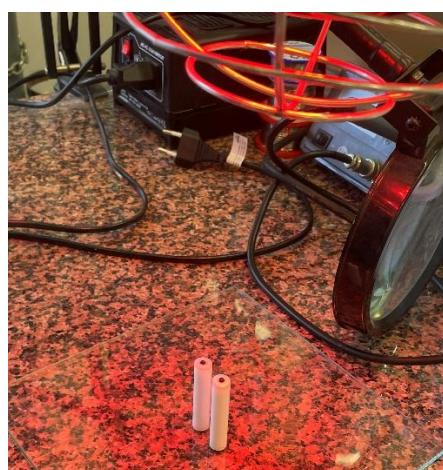
*Slika 3.1. Sušenje GC/GO elektroda ispod IR lampe*
