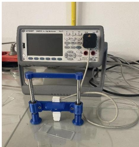
*Slika 3.7. Uređaj za mjerjenje otpora rGO papira*
