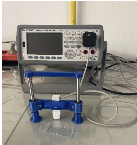
Slika 3.7. Uređaj za mjerenje otpora rGO papira
