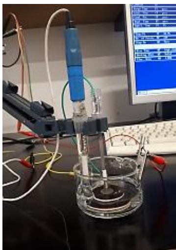
Slika 3.5. Troelektrodni sustav korišten za redukciju GO papira
