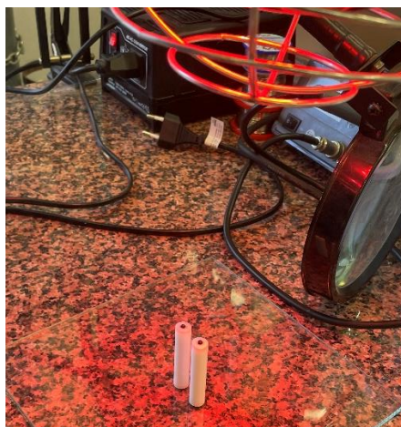
Slika 3.1. Sušenje GC/GO elektroda ispod IR lampe
