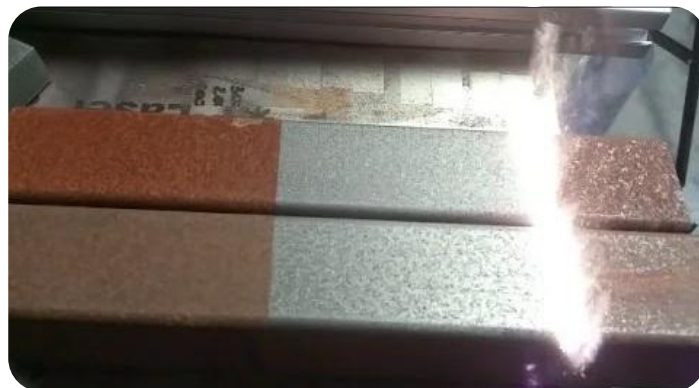
Slika 22. lasersko uklanjanje površinske hrđe s čelika [21]
