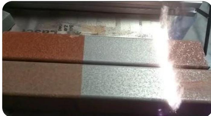
Slika 22. lasersko uklanjanje površinske hrđe s čelika [21]
