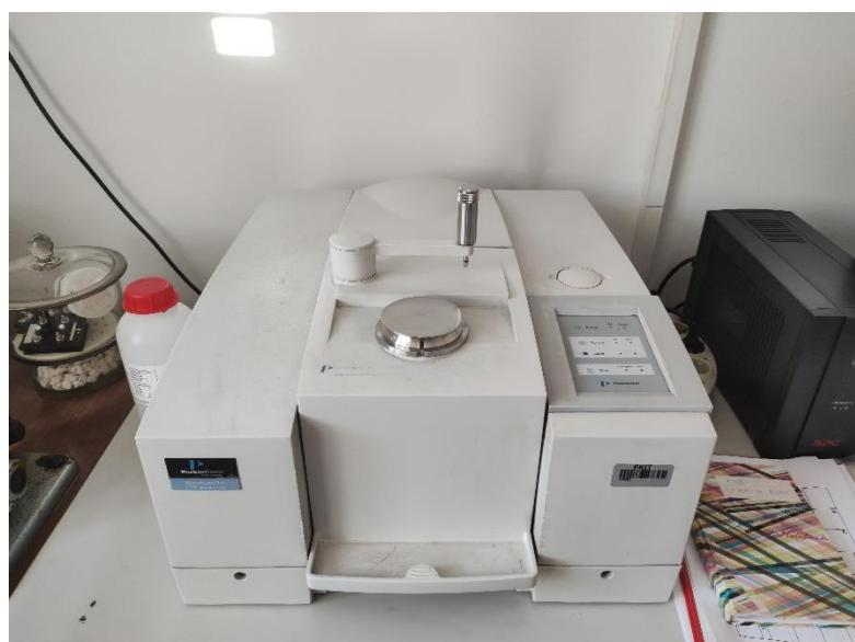
Slika 15. FTIR spektrometar PerkinElmer, Spectrum One
