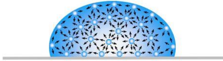
Slika 3. Napetost površine uzrokovana neujednačenošću sila koje djeluju na molekule na površini kapljevine [8]
