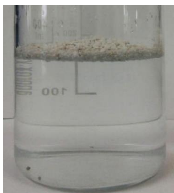
Slika 15. Plutanje perlita na površini vode. [30]
