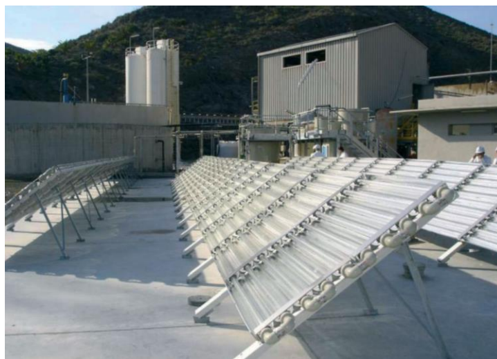
Slika 5. Solarna foto-Fenton jedinica. [8]
