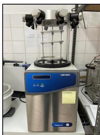
Slika 14. Liofilizator *LABCONCO Free Zone*
