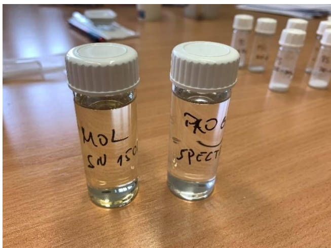
Slika 19. Uzorci ulja korišteni za pripravu ferrofluida – sintetsko ulje te spektralno ulje
