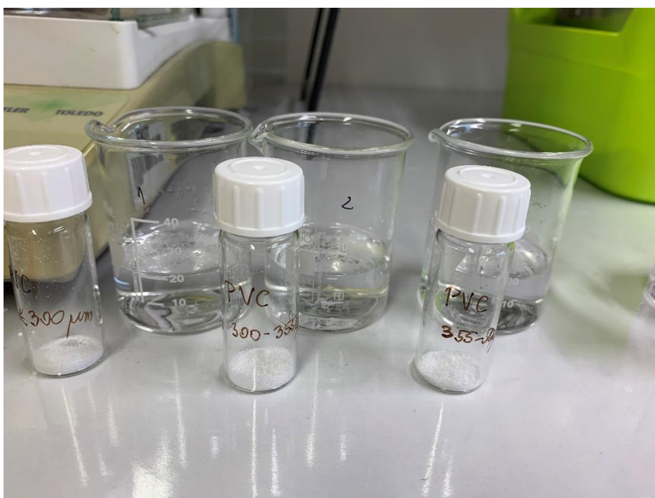
Slika 17. Uzorci mikroplastike PVC-a u rasponu od <math>< 300</math> do <math>500\ \mu\text{m}</math> te pripremljene vodene otopine s mikroplastičnim česticama
