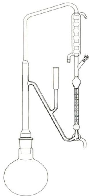
**Slika 5.** Shema aparature za destilaciju vodenom parom
