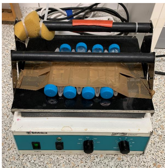
Slika 15. Provedba šaržne ekstrakcije komercijalnog enzima lakaza korištenjem laboratorijske miješalice
