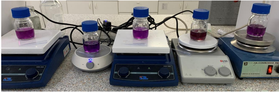
Slika 23. Razgradnja anilinske tekstilne boje u šaržnom reaktoru
