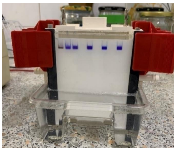
Slika 21. Napunjene jažice s uzorcima
