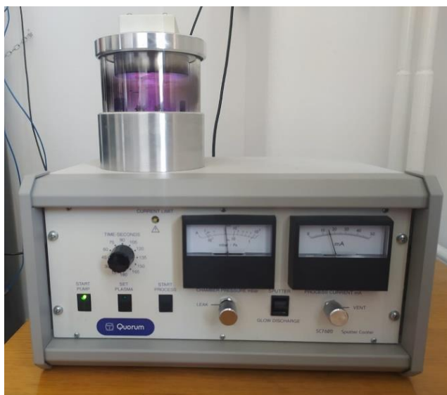
Slika 18. Uređaj za neparivanje uzoraka s vodljivim slojem zlata (lijevo), pretražni elektronski mikroskop Tesca Vega serije 3, Bruker (desno)
