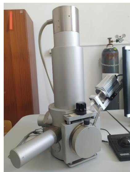
Slika 18. Uređaj za neparivanje uzoraka s vodljivim slojem zlata (lijevo), pretražni elektronski mikroskop Tesca Vega serije 3, Bruker (desno)
