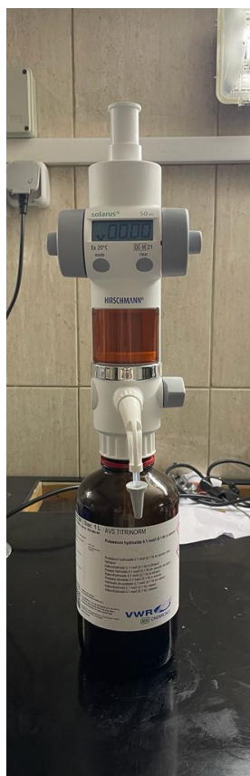
Slika 17. Aparatura za titraciju (poluautomatska bireta)
