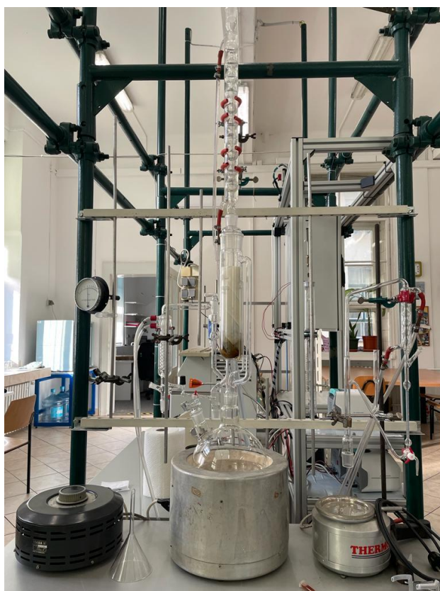
Slika 16. Soxhlet aparatura koja je korištena u laboratoriju
