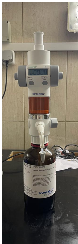
Slika 17. Aparatura za titraciju (poluautomatska bireta)
