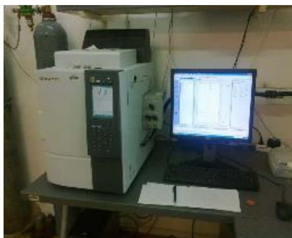
Slika 25. GC - Shimadzu GC-2014 (CIL, INA d.d.)
