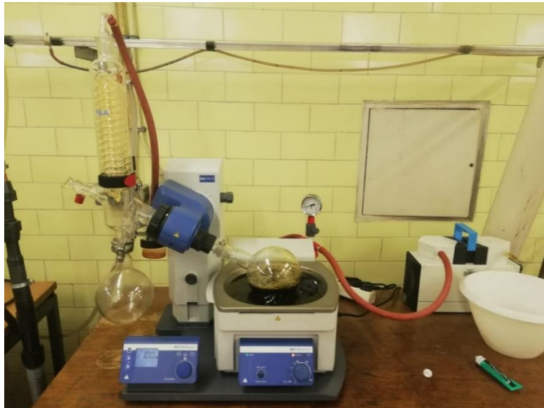
Slika 13. Vakuum isparivač IKA RV 10, rotary evaporator, basic
