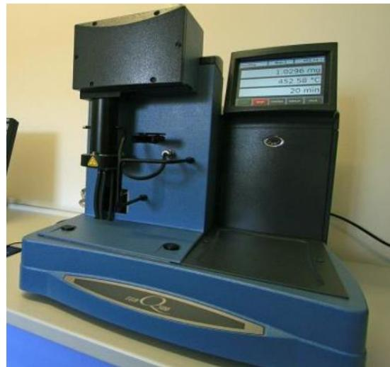
Slika 9. Temogravimetrijski analizator Q 500, TA instruments
