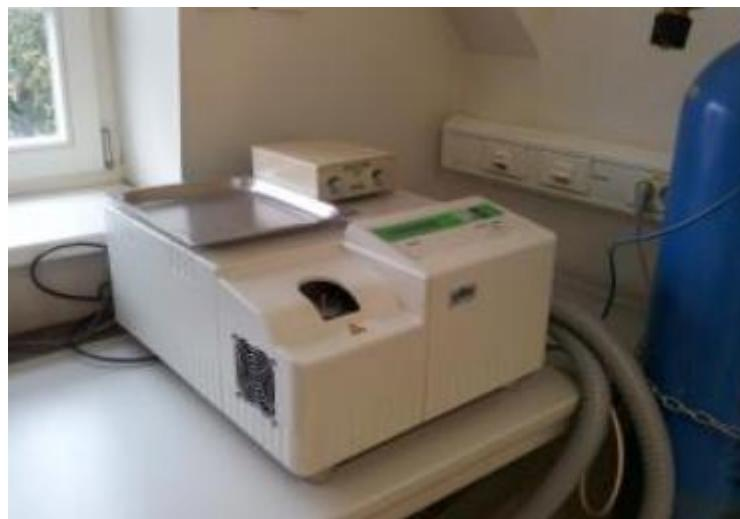
**Slika 8.** Modulacijski diferencijalni pretražni kalorimetar (MDSC), Mettler Toledo DSC 822<sup>e</sup>
