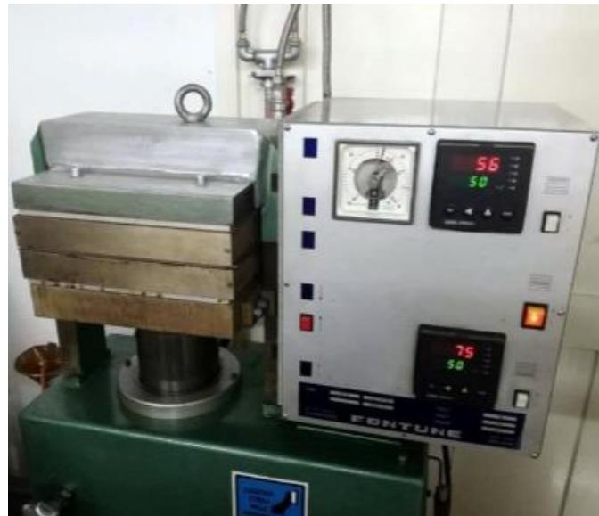
**Slika 7.** Hidraulična preša Fortune Holland
