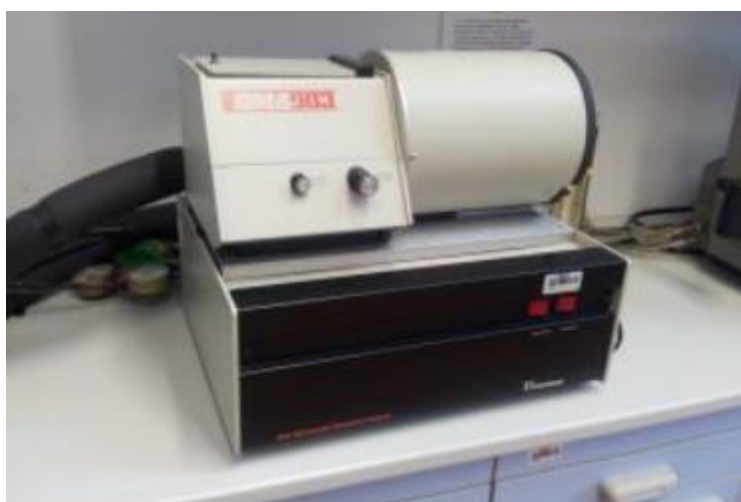
Slika 10. Dinamičko-mehanički analizator (DMA), TA Instruments DMA 983
