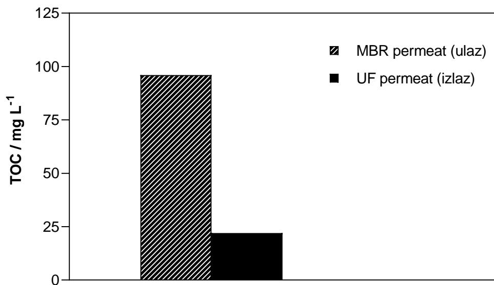
**Slika 11.** Grafički prikaz promjene vrijednosti TOC-a UF procesom.
