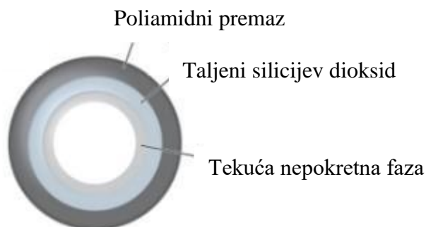
Slika 7. Prikaz kapilarne kolone [9]
