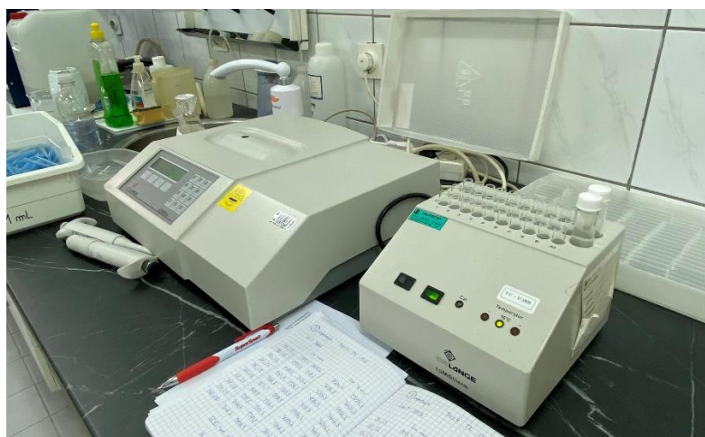
Slika 3.11. Postava aparature za provođenje ispitivanja ekotoksičnosti na Vibrio fischeri .
