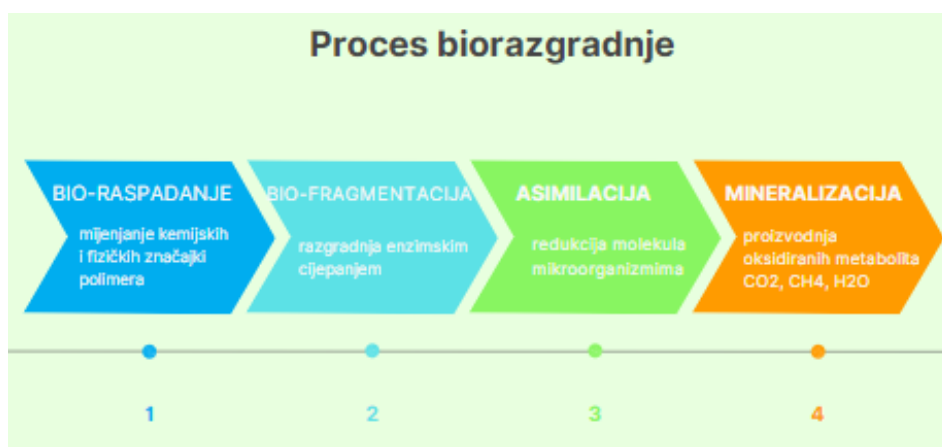
Slika 2.19. Shematski prikaz procesa biorazgradnje. 74
