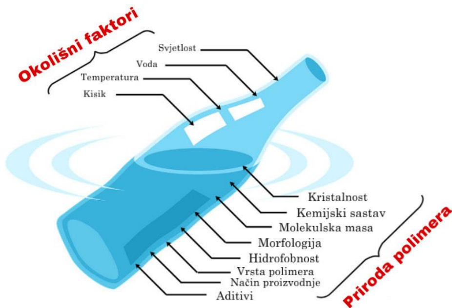
Slika 2.20. Faktori koji utječu na brzinu razgradnje plastike. 22
