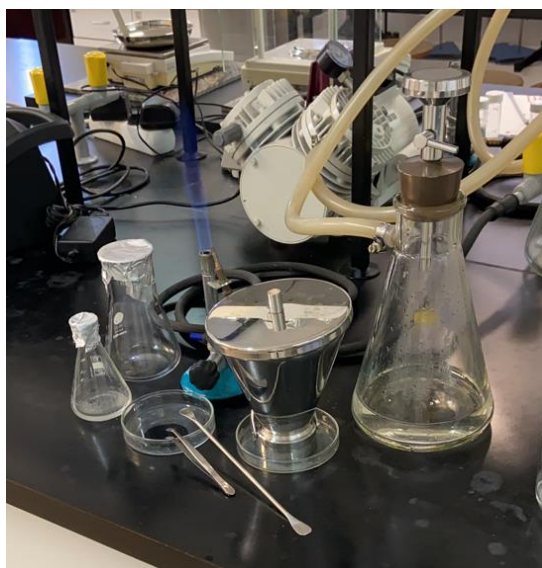
Slika 3.8. Prikaz odvajanja čestica mikroplastike nakon sterilizacije poštujući sterilnu tehniku rada.
