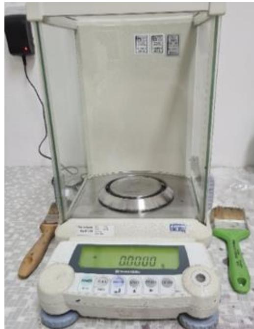
*Slika 3.2. Analitička vaga Shimadzu A UW 120.*
