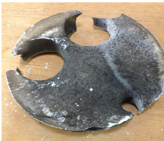
Slika 25. Oštećenja na odlomljenoj pregradi u reaktoru
