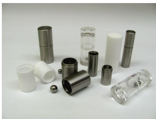
Slika 5. Posudice i kuglice za mlin od različitih materijala
