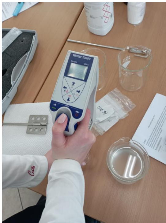
Slika 9. Mjerenje gustoće pomoću denzitometra
