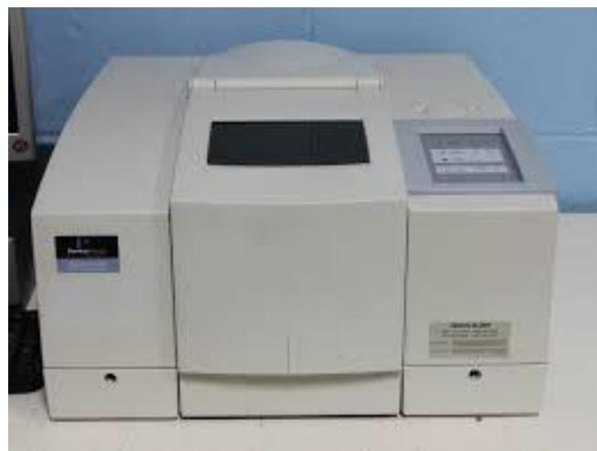
Slika 9. FTIR spektrometar, Perkin Elmer Spectrum One Spectrometer s ATR modulom<sup>[37]</sup>
