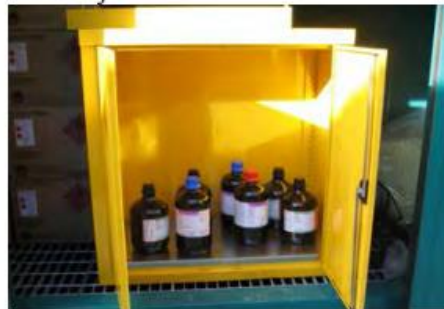
Unutrašnjost sigurnosnog ormarića za zapaljive tvari
