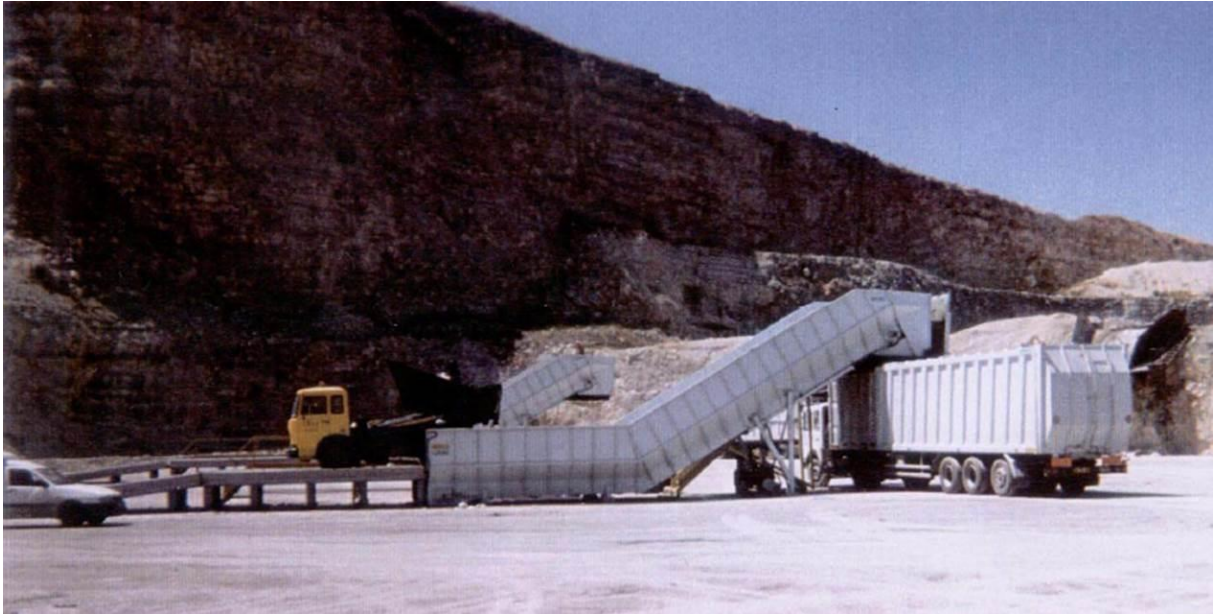
Slika 25. Utovar otpada u poluprikolicu s potisnom pločom
