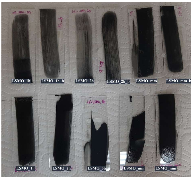
Slika 4. Prevlake nanosene na predmetna stakalca. U prvom redu prikazane su prevlake dobivene iz paste pripremljene u plastičnoj kiveti uz 3 ili 5 kapi PVDF-a (oznaka b = 5 kapi). U drugom redu prikazane su prevlake dobivene iz paste pripremljene u ahatnom tarioniku uz dodatak 5 kapi PVDF-a.
