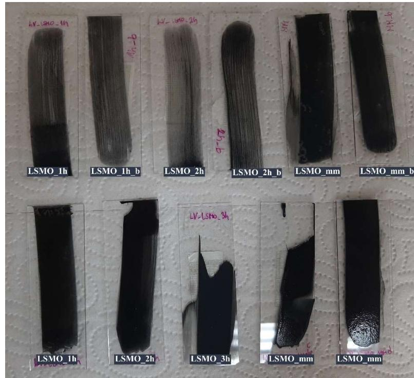
Slika 4. Prevlake nanesene na predmetno stakalce. U prvom redu prikazane su prevlake dobivene iz paste pripremljene u plastičnoj kiveti uz 3 ili 5 kapi PVDF-a (oznaka b = 5 kapi). U drugom redu prikazane su prevlake dobivene iz paste pripremljene u ahatnom tarioniku uz dodatak 5 kapi PVDF-a.
