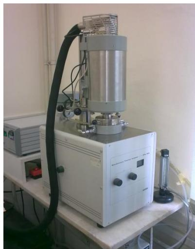
Slika 12. Termogravimetar NETZSCH STA 409
