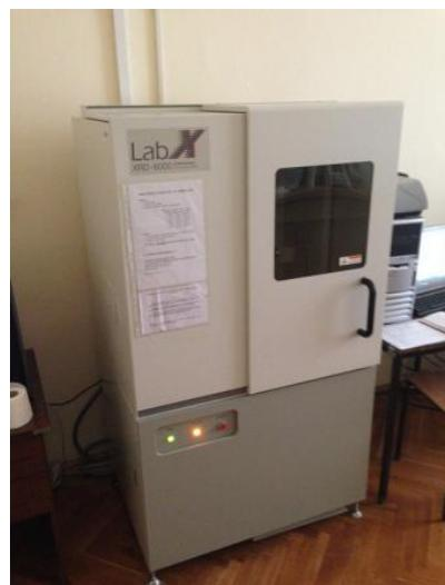
Slika 11. XRD difraktometar Shimadzu D600
