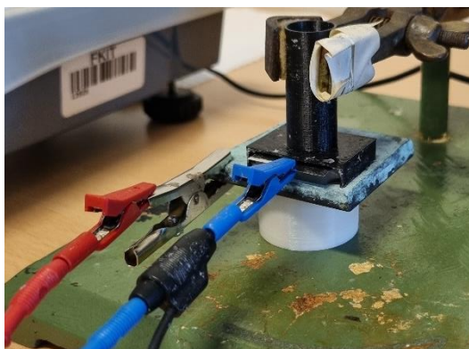
Slika 9. Dvoelektrodni sustav sa hidrogelom i Pt elektrodom
