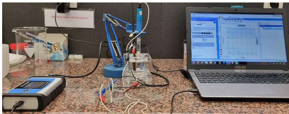
Slika 11. Aparatura za EIS mjerenje u troelektrodnoj elektrokemijskoj ćeliji sa tekućim elektrolitom
